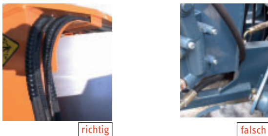
Abbildung 10: Vermeidung von Abknicken oder Scheuern
