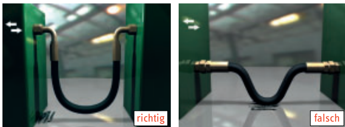
Abbildung 9: Vermeidung von Abrieb durch ausreichende Bewegungsfreiheit
